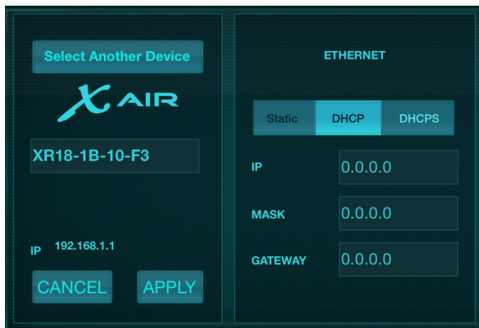
Nom du mélangeur et écran de configuration Ethernet
